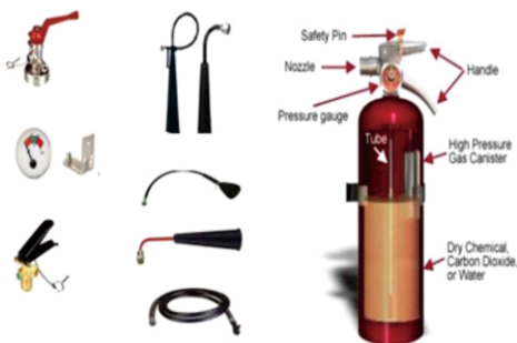
Gambar 5.9. Komponen Alat Pemadam Api Ringan Sumber: https://www.bromindo.com/mengenal-alat-pemadam-kebakaran/
