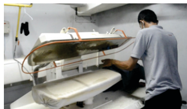
Gambar 5.37. Penggunaan mesin shirt press unit Sumber : Laundry Eastparck Hotel Yogyakarta , 2018
