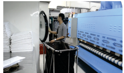
Gambar 5.26. Persiapan mengeluarkan linen dari drying tumbler Sumber: Hotel Eastparc Yogyakarta, 2018
